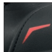
GÜK mit versenkten Nähten
